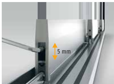
In hoogte verstelbaar Ter compensatie van eventuele verzakkingen kunnen de loopwielen ook in ingebouwde toestand nog tot 5 mm in hoogte worden veresteld.
